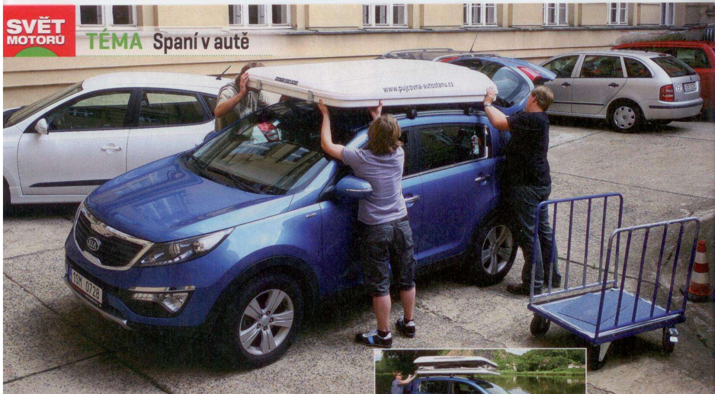
Než postavíte autostan, musíte odjistit pojistky a klikou střechu vytočit
